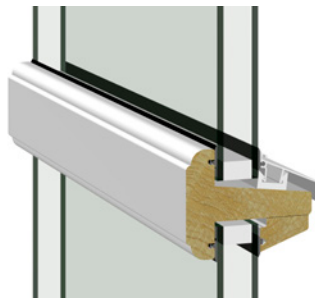
GJENNOMGÅENDE HORIZONTAL SPROSSE - INNSIDE
