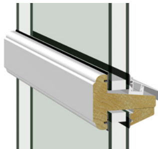
GJENNOMGÅENDE HORIZONTAL SPROSSE - INNSIDE
