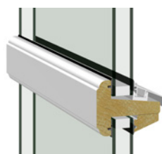
GJENNOMGÅENDE HORIZONTAL SPROSSE - INNSIDE
